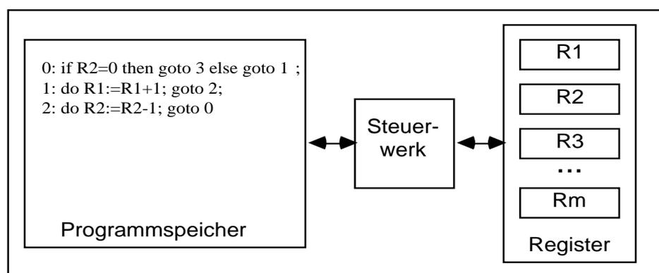
Abb. 2: Registermaschine
